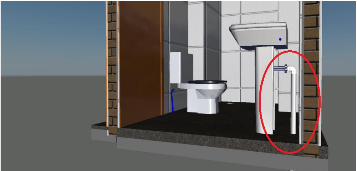
Figura 55 - Tubulação movida para fora da parede
