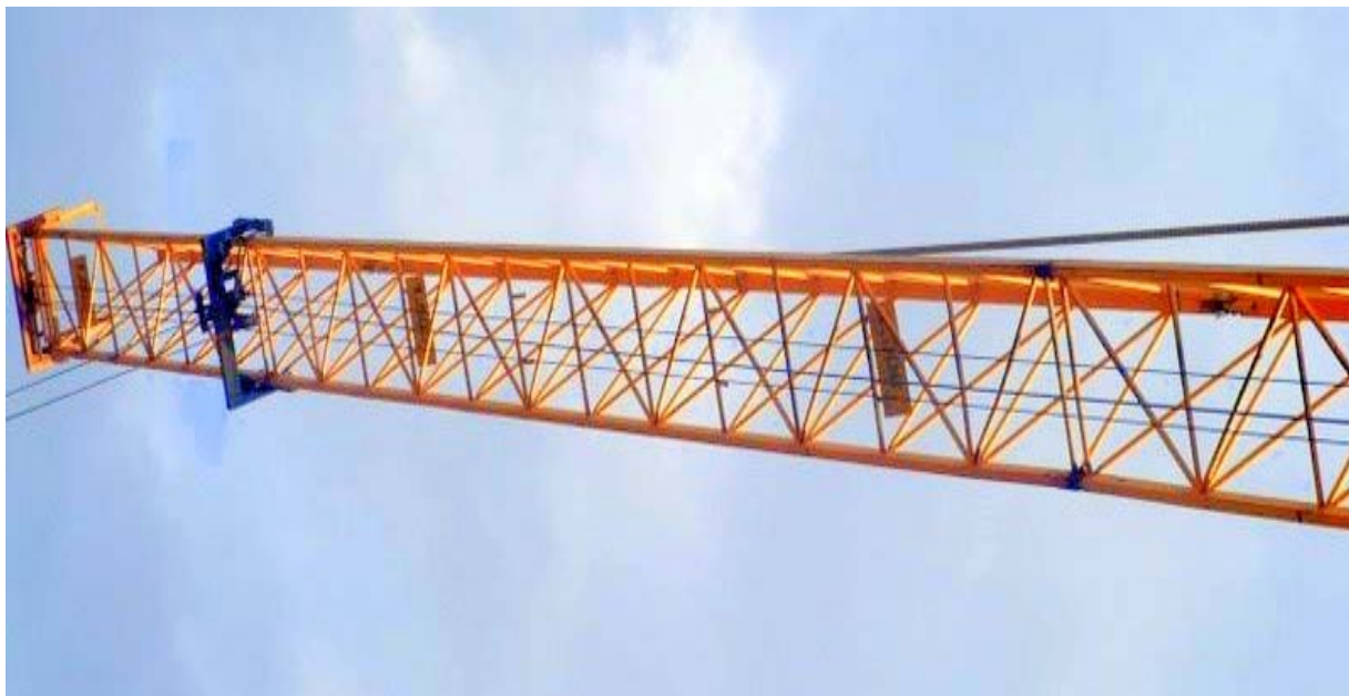
Figura 09. Imagem da lança da grua da obra 8 com placas de carga máxima.
