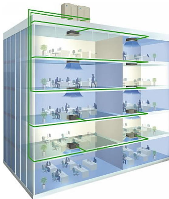
*Figura 8 - Simulação de alimentação do sistema VRV (Daikin, 2011)*
