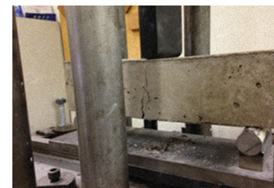
FOTOGRAFIA 4 • Ensaio de resistência à tração na flexão.
