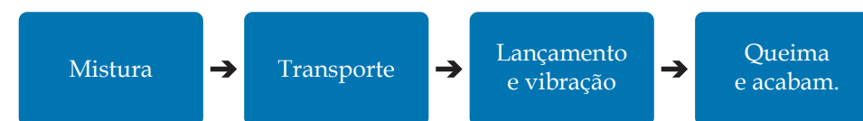
FIGURA 2 • Ciclo de Concretagem para o Concreto Auto Adensável
