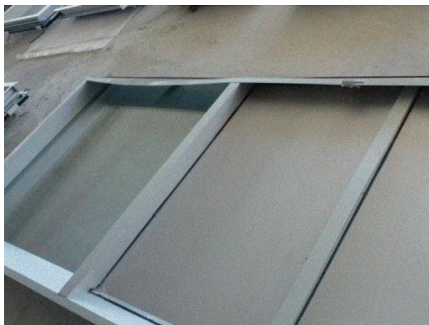
FIGURA 13 • Módulo empenado durante o transporte
