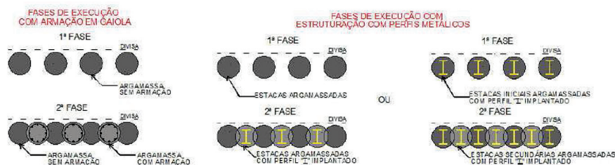
FIGURA 3 • Fases executivas das estacas secantes.
