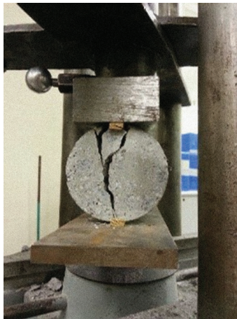
FIGURA 3 • Corpo de prova cilíndrico sendo submetido à tração por compressão diametral. FONTE: Acervo próprio (2014)
