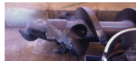
FIGURA 6 • Detalhe da ponteira com saída lateral.
