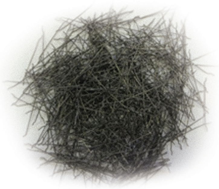
FOTOGRAFIA 1 • Fibras de aço utilizadas nesta pesquisa.
