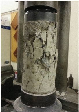
FIGURA 2 • Corpo de prova cilíndricos sendo submetido à compressão axial. FONTE: Acervo próprio (2014)
