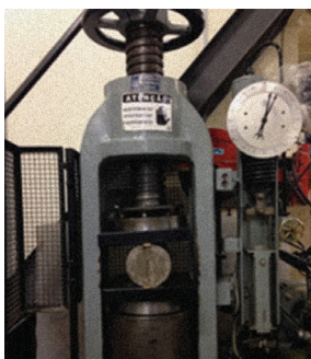
FOTOGRAFIA 3 • Ensaio de resistência à tração por compressão diametral.
