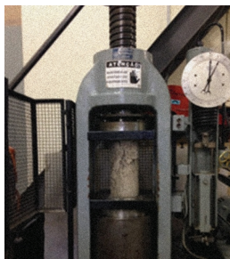
FOTOGRAFIA 2 • Ensaio de resistência à compressão axial.
