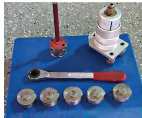
**FIGURA 16 • Teste de determinação da aderência após 48 horas de aplicação do revestimento**
