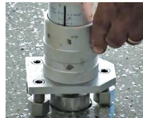
**FIGURA 17 • Retirada de cinco corpos de prova, com média de rompimento no concreto de 1,7 MPa**
