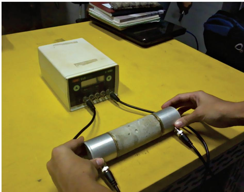
**FIGURA 1** • Realização do ensaio de determinação da velocidade de propagação da onda ultrassônica
